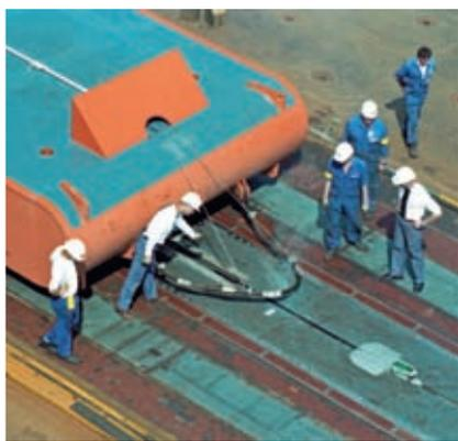
**1997.** DE GROSSES MAQUETTES D'UNE MASSE DE 10 À 30 TONNES SONT PROJETÉES À 100 MÈTRES À L'AVANT DU PORTE-AVIONS POUR TESTER LA CATAPULTE. ELLES SONT ENSUITE RÉCUPÉRÉES POUR DES TIRS ULTÉRIEURS.
